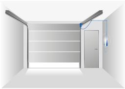
Bei verbautem Seitenanschlag, z. B. durch eine Nebentür, kann eine Kabelverlängerung eingesetzt werden.
