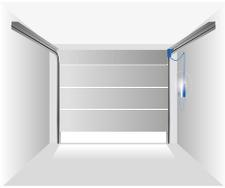
Antrieb an der rechten Torlaufschiene, Steuerung auf der rechten Garagenwand
