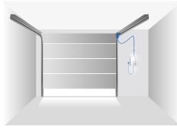
Antrieb an der rechten Torlaufschiene, Steuerung direkt neben dem Tor im Bereich des Seitenanschlags.
